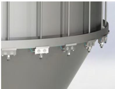
Otro diseño conceptual para celdas de carga a través de una perforación para tanques subterráneos.
